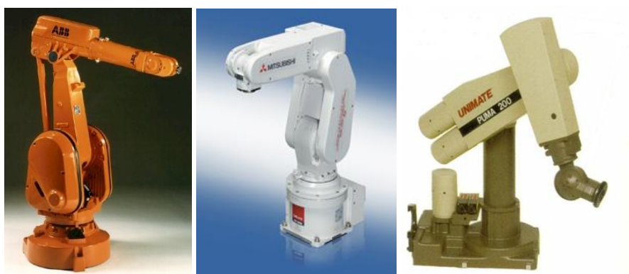
c. Roboți în coordonate articulat- sferice cu arhitectură generală de tip „braț articulat”
