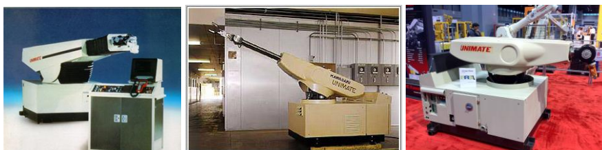
a. Roboți în coordonate polar-sferice cu arhitectură generală de tip „turelă”
