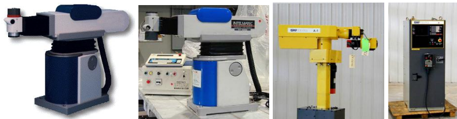
b2. Roboți în coordonate cilindrice cu arhitectură generală de tip „pistol”
