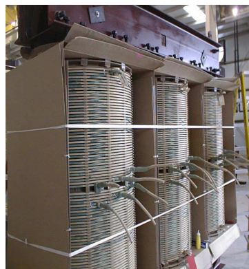
b) transformator trifazat
